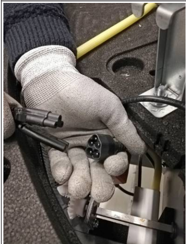
Afb. 33: Kabel losmaken
