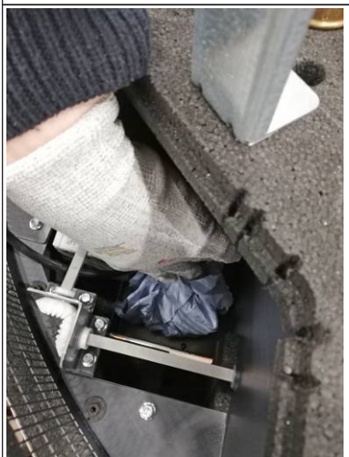
Afb. 34: Pompbak reinigen
