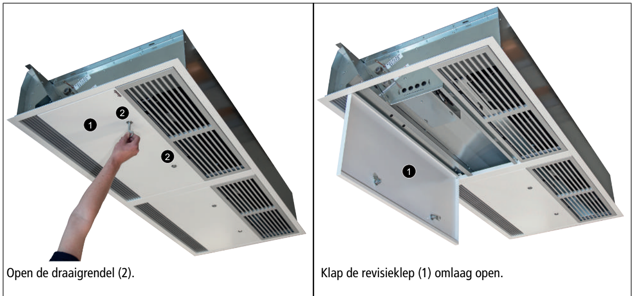
Afb. 33: Revisieklep openen, Tandem plafondinbouw
