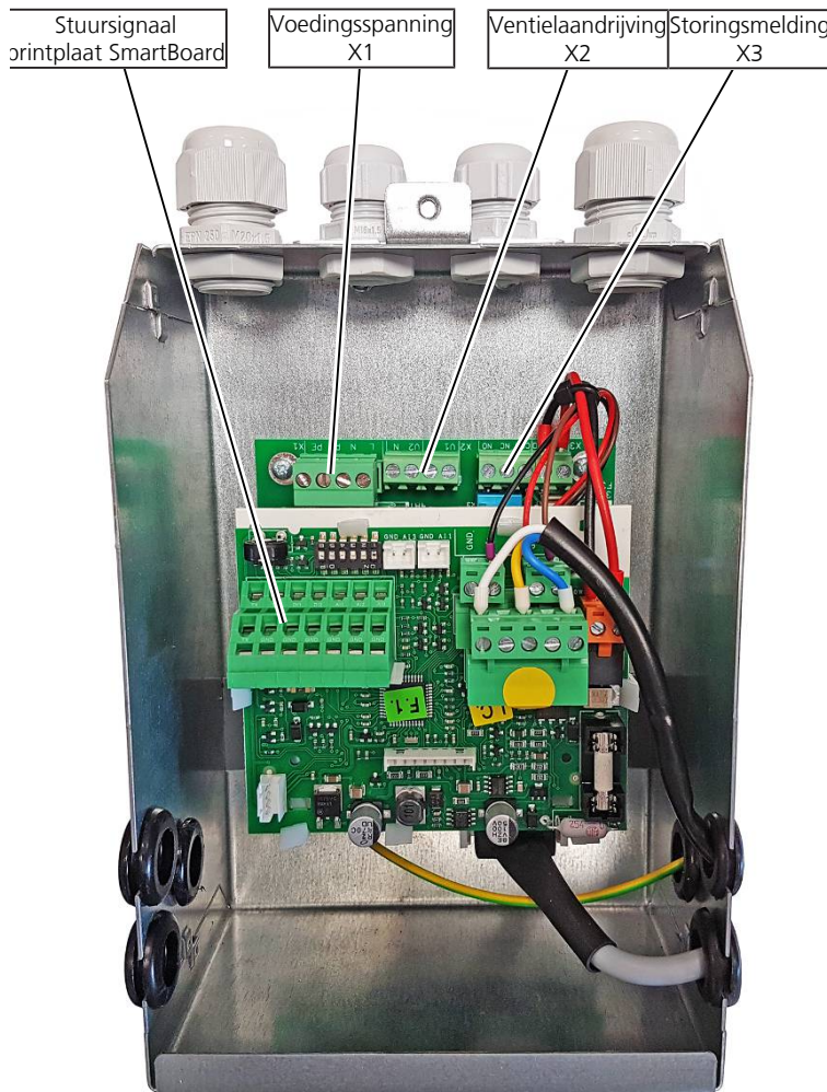
Afb. 27: Printplaat in de elektrische aansluitkast
