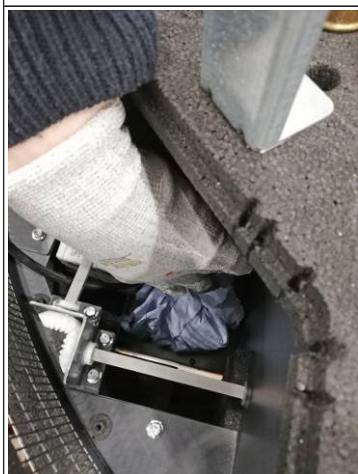
Afb. 36: Pompbak reinigen
