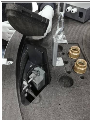
Afb. 34: Afdekking revisieopening
