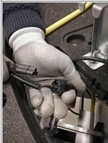
Afb. 35: Kabel losmaken
