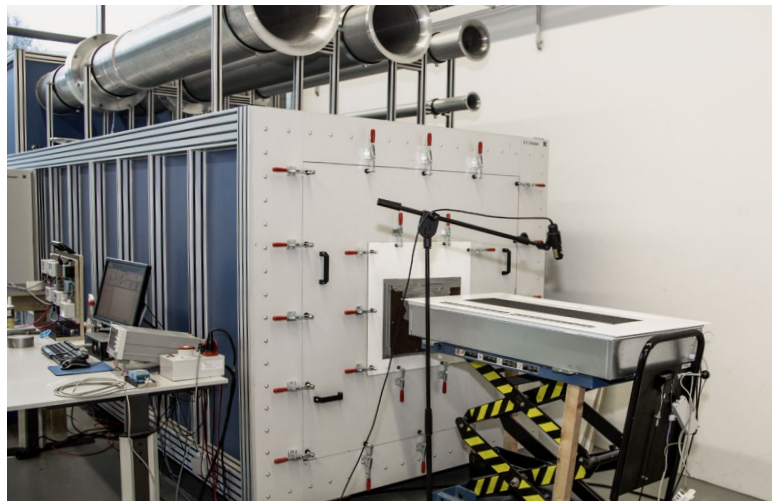
Kamertestinstallatie voor luchtprestatiemetingen; Kampmann Onderzoeks- en Ontwikkelingscentrum
