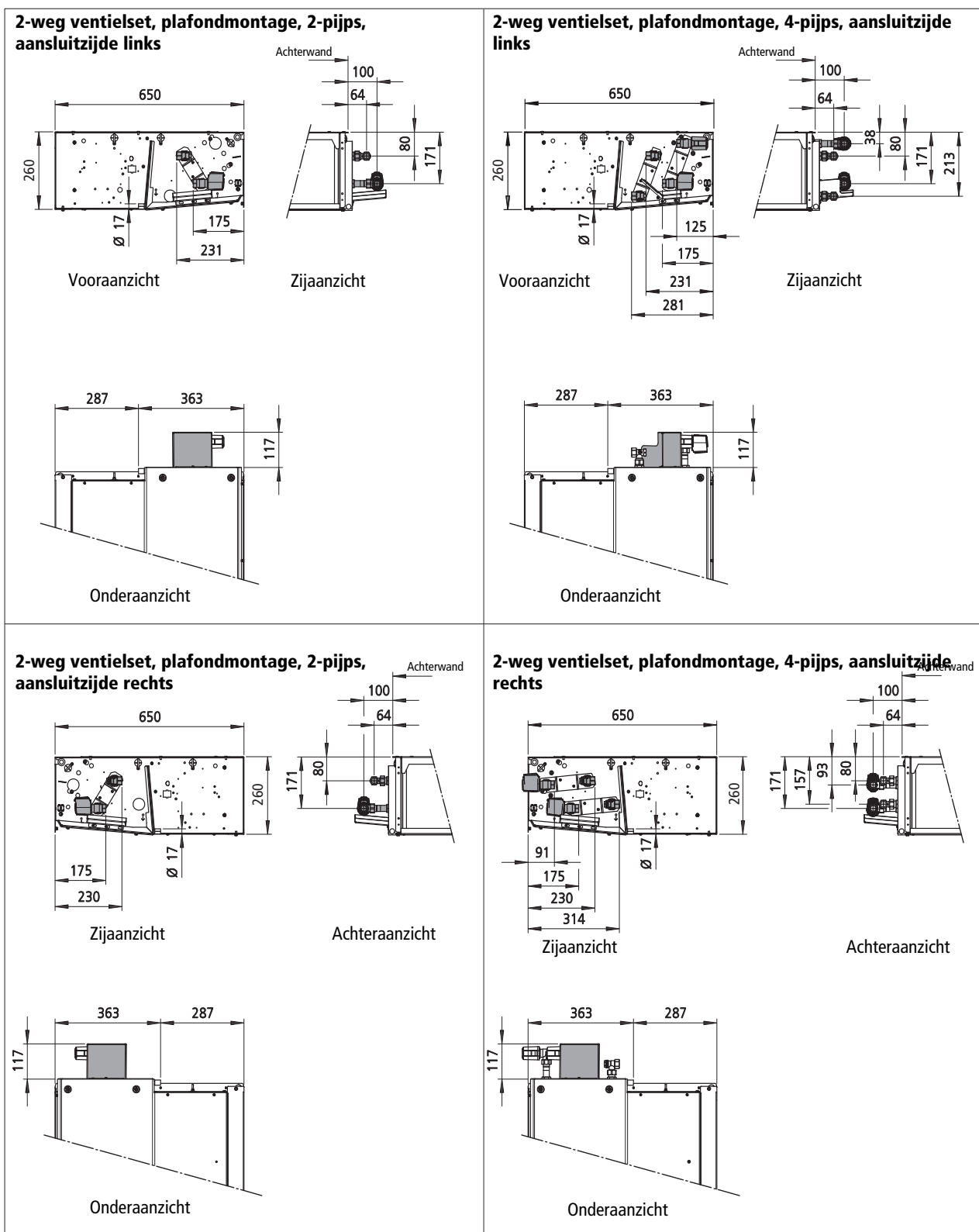
Afb. 12: Afmetingen 2-weg ventielset (plafonduitvoering)
