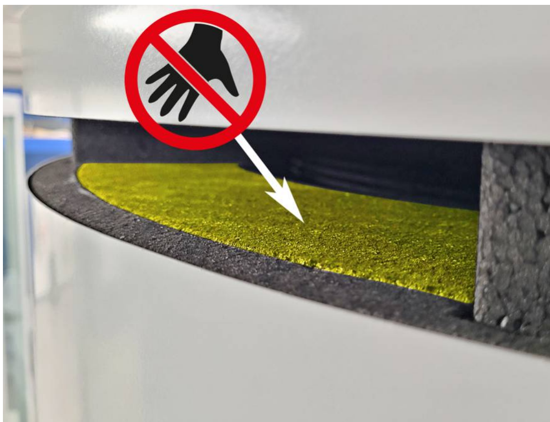
Afb. 20: Gebruik dit gebied niet voor het neerlaten van het onderste deel van het apparaat!
