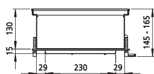
Zijaanzicht met gemonteerde condensaatpomp
