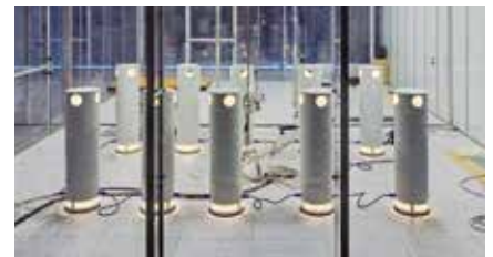
Testinstallatie van 10 dummy's met capaciteitsregeling
