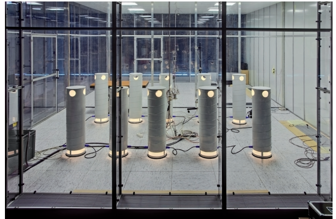
Testopstelling van 10 vermogensgeregelde dummy's
